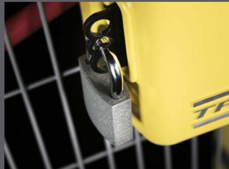
Durch zusätzliches Anbringen eines Vorhängeschlosses wird verhindert, dass die Tür bei Wartungsarbeiten verschlossen wird.
