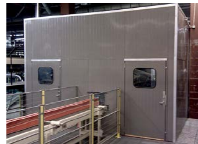
6 VOLLBLECH LÖSUNGEN Die Vollblechelemente werden vor allem zum Schutz bei Schweiß- und Schneidmaschinen eingesetzt.
