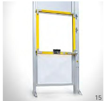
**Prozesszuhaltung** | Eine Magnetverriegelung wird als Prozesszuhaltung verwendet (verhindert Prozessstörungen in Maschinen ohne Nachlaufzeit) und kann zur Verwendung in Sicherheitsanwendungen mit einem Sicherheits-sensor genutzt werden. Solange der Magnet unter Spannung steht, ist die Tür verriegelt, je nach Stärke des Magneten beträgt die Haltekraft maximal 1200 N.
