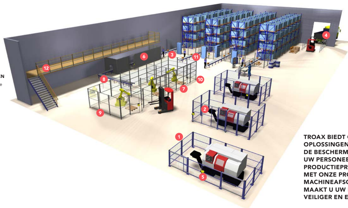
3 HOGE AFSCHERMINGEN Met de koppelstukken is het heel eenvoudig om hoge wanden te bouwen met standaardpanelen en -staanders.
