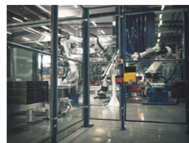
10 POLYCARBONAATPANELEN Zorgen voor een goed overzicht en bieden bescherming tegen vloeistoffen en kleine deeltjes.
