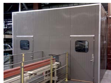
6 OPLOSSINGEN MET VOLLE PLAATPANELEN Onze URSP volle plaatpanelen zorgen bij montage met het Safe Fix systeem voor een afgesloten cel die geschikt is voor lastoepassingen.
