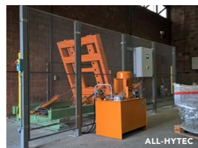
1 STRONG FIX Onze meest krachtige machineafscherming die bestand is tegen een impact van 2.500 J.
