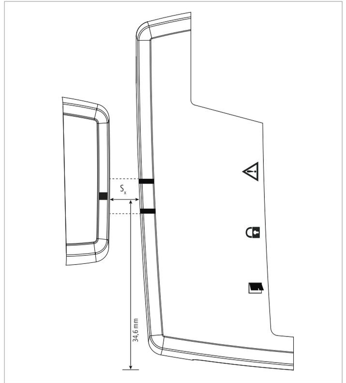
Abb.11:  $S_x$  entspricht  $S_{ao}$ ,  $S_n$ ,  $S_{ar}$
