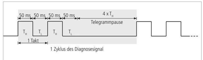
Abb.15: Pulsdiagramm - Werkseinstellung Beispiel für Takt 2x.
