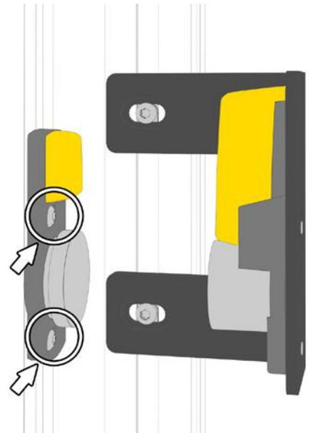
Abb.9: Ankerplatte am Profil der Schiebetür anbringen, zur Prozesszuhalterung ausrichten und zur Prozesszuhalterung ausrichten. Schrauben M6 x 16 mm Torx festziehen.
